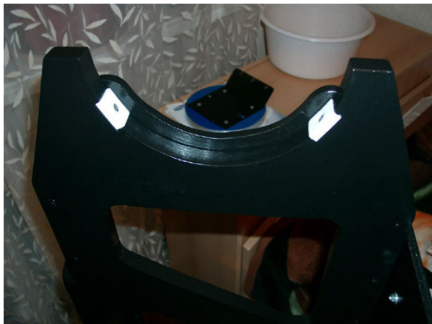
Полуоси скользят по двум фторопластовым опорам
