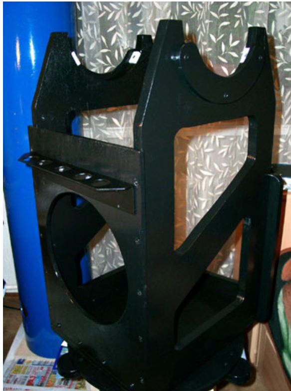
Сзади сделана полка на 5 окуляров 1,25 дюйма
