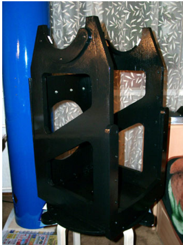
Монтировка – видно "ярмо" препятствующее противоходу
