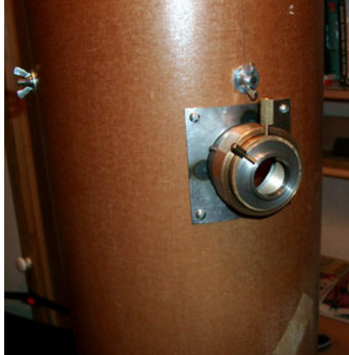
Гайки паука не мешают креплению фокусировочного узла
