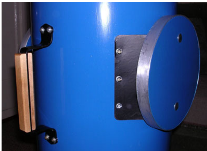
К внутренней стороне дисков, шурупами привинчена пластина из стали 0,8мм, края которой были отогнуты вверх в виде трапеции, для крепления к трубе, что существенно повышает жесткость всего узла в целом.
