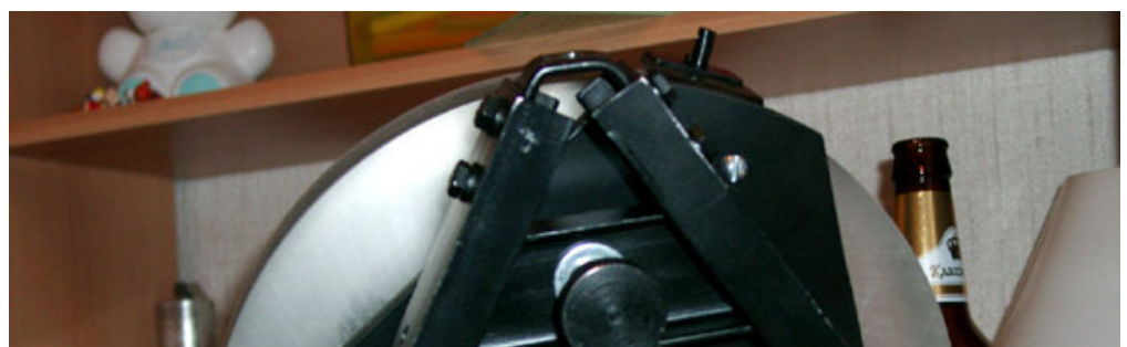
Юстировка осуществляется винтами, пропущенными через мощные отжимные пружины
